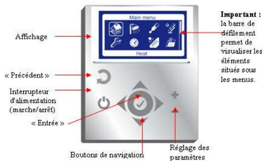
L'utilisation du tableau de commande repose principalement sur l'emploi des boutons et du cadran de menu qui permet à l'utilisateur de naviguer entre les différents menus et paramètres.
